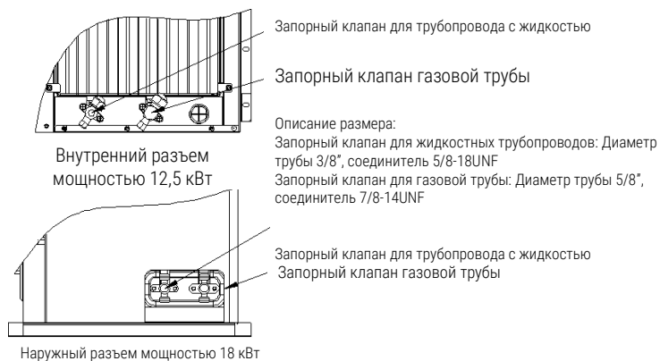
Рисунок 3-8 Принципиальная схема соединения трубопроводов внутреннего и наружного блоков
